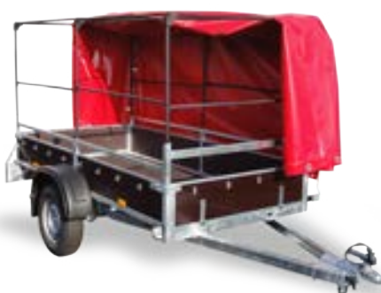
Trubková konstrukce plachty
