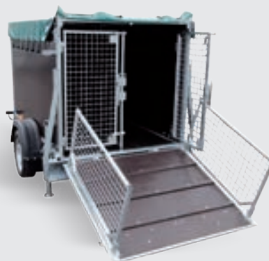
Zadní rampa s výklopným zábradlím
