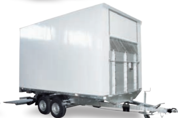
Hydraulická rampa vzadu a vpředu přejezdové čelo
