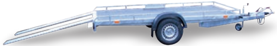
Plato s nájezdy uloženými pod ložnou plochou
