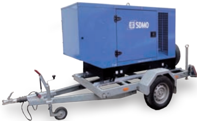
Podvozky pod generátory
