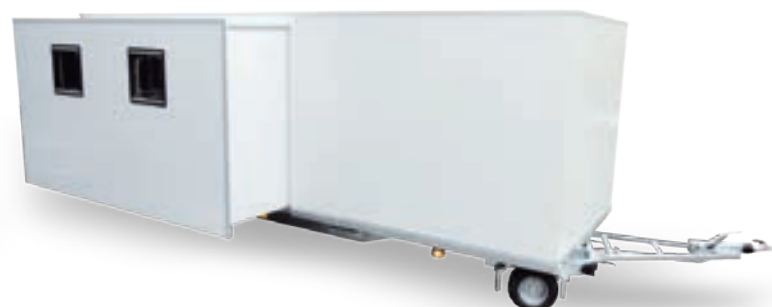
Točna se skříní s výsuvným bokem
