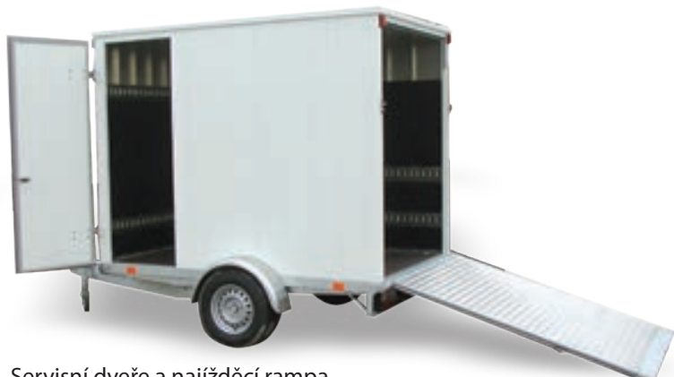
Servisní dveře a najížděcí rampa
