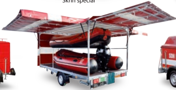
Přestavba PS 12 na podvozek Vezeko
