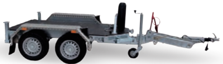
Podvozky pod generátory
